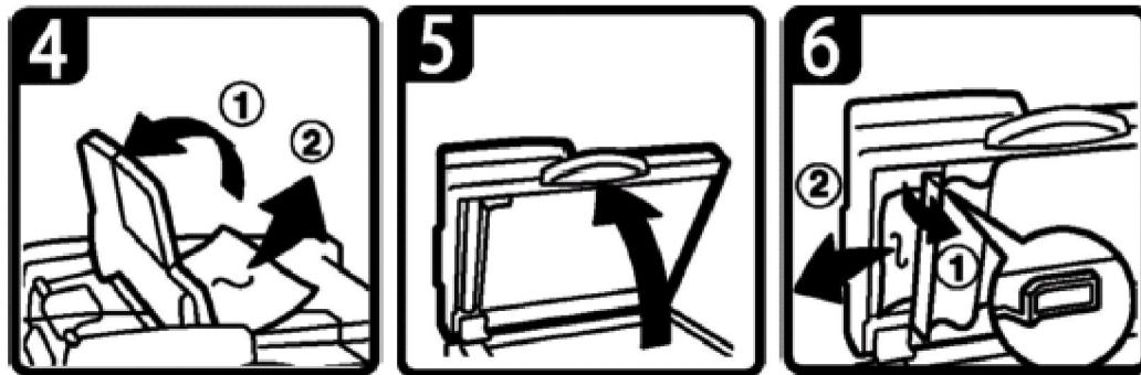
Kẹt giấy khi sao chụp hai mặt (H4), mở khay bản gốc lên (1), rút giấy kẹt (2). Nếu giấy kẹt ở đường ra giấy của thiết bị, mở thiết bị tự động nạp bản gốc lên (H5), nhấn vào núm màu xanh lá (H6) để mở cửa (1), sau đó lấy giấy kẹt (2).
