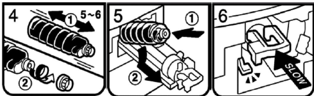
Lắc ống mực mới (H4) theo chiều ngang (1) khoảng 5-6 lần, mở nắp đen của ống mực ra (không mở nắp trắng nhỏ). Đặt đáy ống mực (H5) mực xuống trước (1) , sau đó đặt ống mực nằm ngang và đẩy sát vào theo chiều mũi tên (2). Đẩy chậm (H6) khối bơm mực vào máy đến khi nào được gài vào chốt xanh lá. Nhấn (H7) cần khoá xuống.
